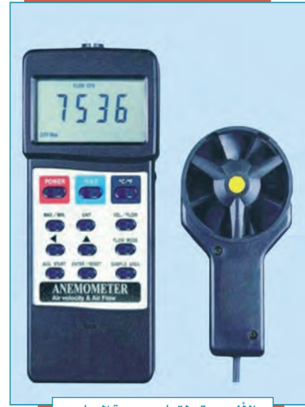
الأنيمومتر لقياس سرعة الرياح
